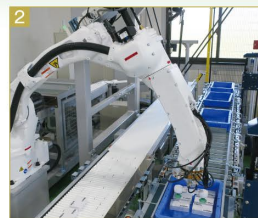
小型6軸ロボット (最大処理能力:2.2秒/サイクル)
