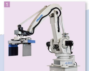
ロボットパレタイザAi1800 (最大処理能力:1720サイクル/h)
