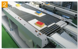
高速3方向分岐装置 (最大分岐能力:18000個/h)
