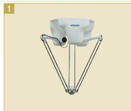
パラレルリンクロボット (最大処理能力:0.94秒/サイクル)
