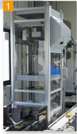
ミニパーフェ (最大処理能力:4500個/h)
