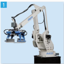
ロボットパレタイザA400V (最大処理能力:400サイクル/h)
