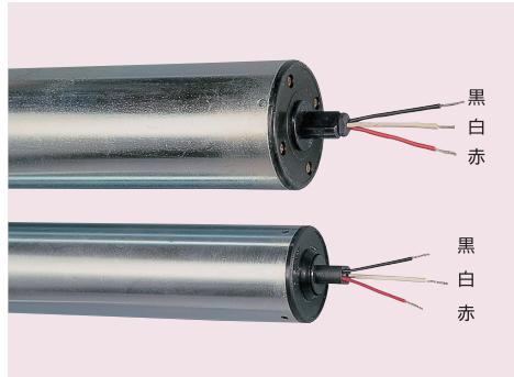
・モータローラの給電側のリード線は黒(白)赤の3線です(但しブレーキ仕様、またはPSS-E:ドライブ・フリーは5線です)。3本のリード線の内2本の線を入れかえることにより、回転方向を変えることができます。多数のモータローラを使用する場合、リード線を全て同一に結線すると回転方向が同じになります。
