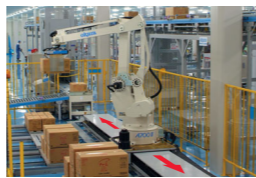
走行軸を使った自走ロボット、1台で複数パレットに積み付ける。
