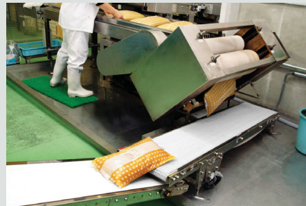
食品工場 水気がベルト表面に留まりにくいメッシュトップベルトを装備したJQLが、水切り工程に採用されました
