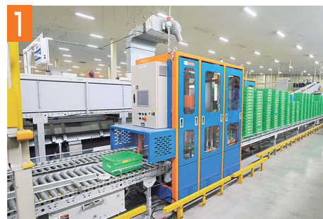
オリコン自動組立装置
