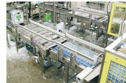
ステンレス製フラットバー+樹脂レール (調整タイプ)
