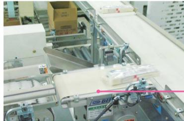
短機長コンベヤの速度を上流コンベヤより高速にすることで、搬送物を切り離しメインラインに合流させます。
