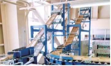
コロコンキャリアーやパイプを使い、傾斜をつけて重力で搬送します。空箱供給などに使用します。
