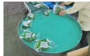
ライン末端でのパッファ機能や方向転換に適しており、比較的安価に設置できます。ステンレス製もラインナップしています。
