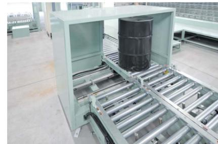
ドラム缶を2ラインへ振り分ける駆動式トラバーサ
