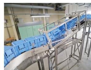
重力を活用して反転させます。洗浄機の上流に設置します。
