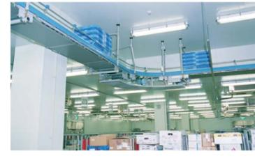
限られた空間を有効に活用するため天井にコンベヤを吊り下げ、人や台車の自由な動線を確認します。
