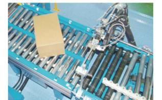
両面印字等搬送方向の変更が必要な次工程への送り込み
