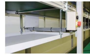
天井吊りなど高い位置にコンベヤを設置する際に、ゴミやホコリの落下を防ぐゴミ受けカバーです。頭上の巻き込まれ防止対策としても有効です。駆動部はメンテがし易いように透明カバーを付けています。
