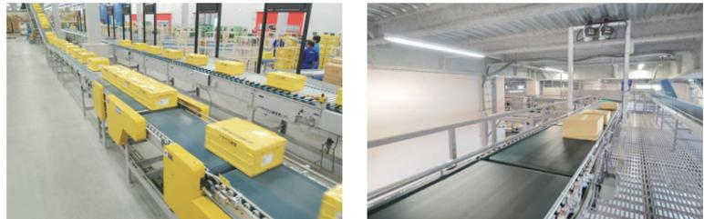
短機長のベルトコンベヤの速度を上流コンベヤより高速にすることで、搬送物を確実に1個ずつ切り離します。
