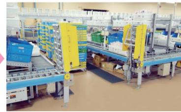
台車などを通すため両側をはねあげ(折りたたみ脚付)、通路幅を確保します。
