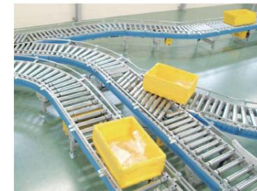
ローラを30°首振りさせて搬送物を分岐させます。
