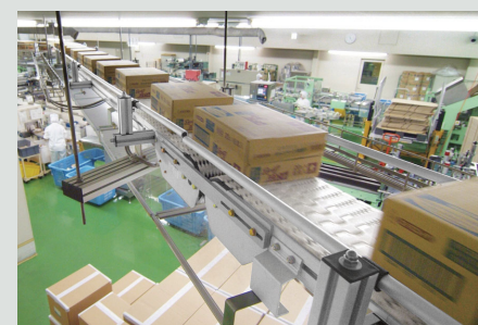
カップメン工場 軽量のオークラキャリーラインは、簡単な吊り上げ材料でセットできます
