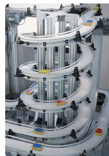
傾斜スパイラル
