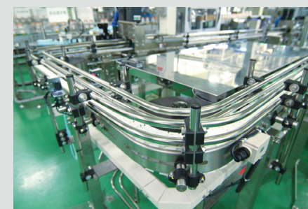
飲料工場 紙パック充填後は、水滴が付着するためステンレスフレームタイプを採用しています
