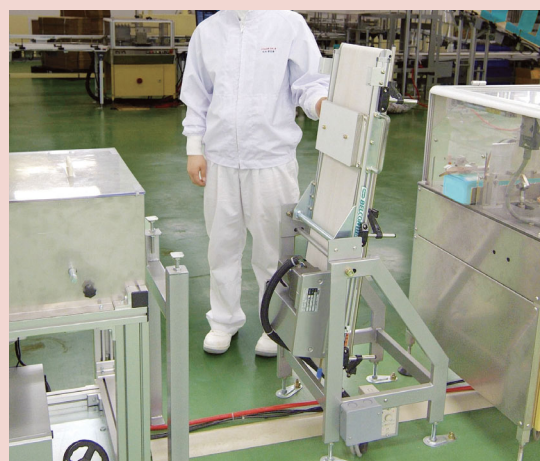
女性作業中でもベルコンミニのはね上げ装置なら楽に持ち上げることができます
