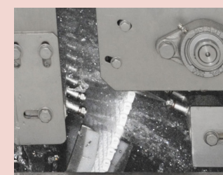
高圧ノズルでベルト両面を効率的に洗浄
