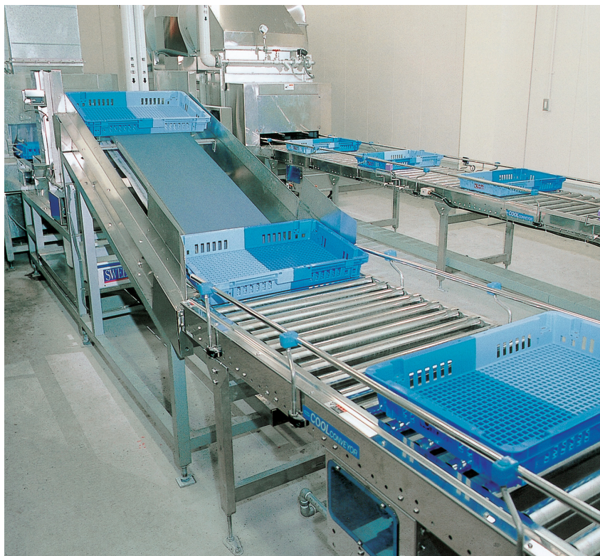
洗浄機への投入・排出ライン
