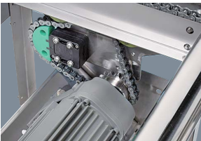
チェーン駆動タイプはオートテンション機構
