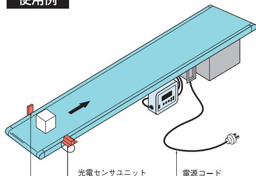
※カウンタは8桁の加算動作、計測速度は30CPSです。
