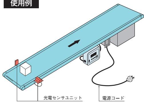
※カウンタは8桁の加算動作、計測速度は30CPSです。
