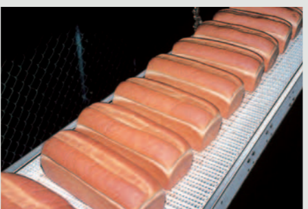
製パン工場 通気性に優れたフラッシュグリッドベルトを装備し、冷却工程に採用されたJPL
