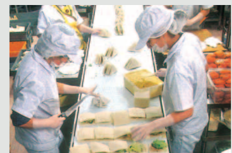
サンドイッチ工場 作業テーブルに代わり、JQL上でカット作業を行うことで作業効率が大幅に向上しました
