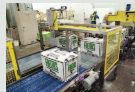
輸入野菜物流センター フラットトップベルトを搭載したJPL。ケース底面の状態が悪くても、ベルト上面が平らで小ピッチなフラットトップなら、確実に運ぶことができます
