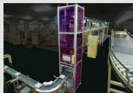
通路対策 2台のミニパーフェが設置された包装ライン
