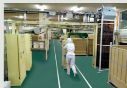
ラインの立体化により確保された資材供給通路
