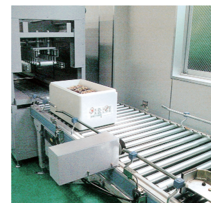
封かん機の投入ライン
