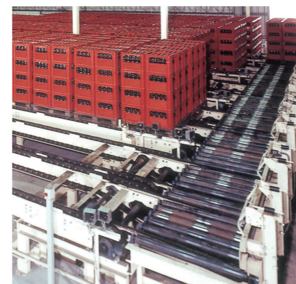
実コンテナの搬送ライン
